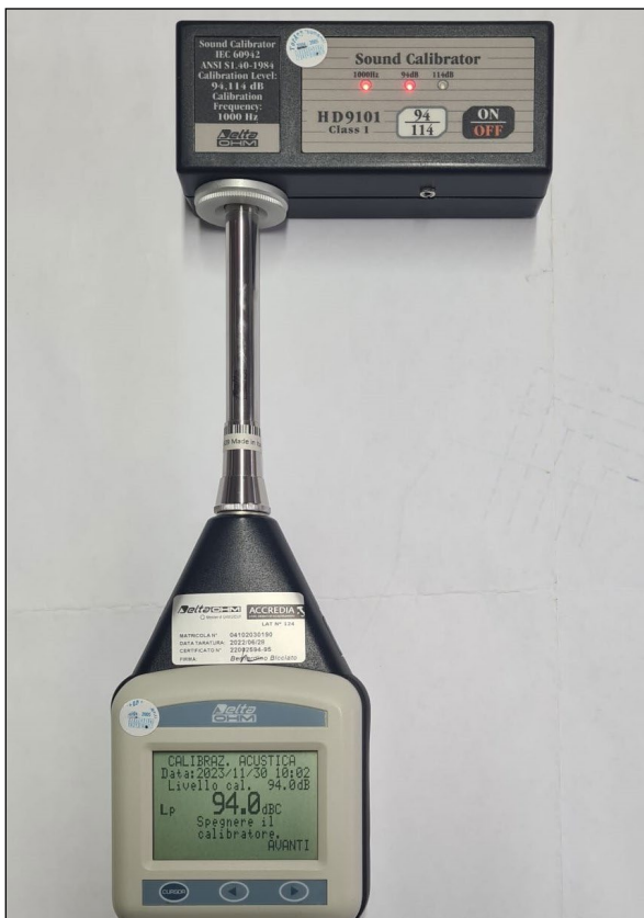
Taratura iniziale fonometro HD 2110
